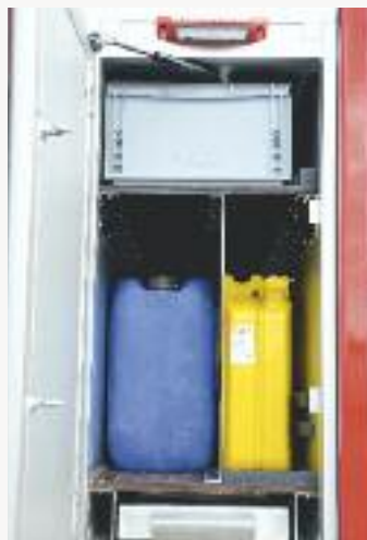
Unter den Ausrüstungsgegenständen des Lastfahrzeuges befindet sich auch ein Behälter mit Ölbindemittel. Damit die Fächer aufgrund der Fahrzeughöhe durch die Feuerwehrkameraden auch erreicht werden können, ist die dazugehörige Leiter ebenfalls gleich im Fach mitverstaut.
