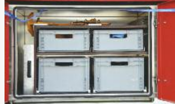
Sicherheit am Einsatzort während und nach dem Einsatz sind besonders wichtig. Daher gibt es auch im zweiten Fach der Fahrerseite Absicherungsmaterialien. Außerdem werden Gegenstände und Geräte zur Fahrzeugbergung selbst mitgeführt wie zum Beispiel Endlosschlingen.
