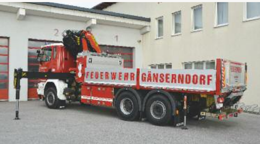
Damit das Fahrzeug stabil steht und für Kranarbeiten verwendet werden kann, ist eine Abstützung notwendig. Auf beiden Seiten sind jeweils zwei Abstützungen vorhanden.
