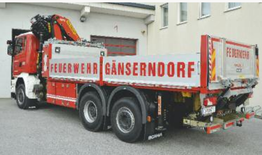
Damit das Verladen von Gegenständen, Paletten mit Sandsäcken, Schadstoffcontainer einfach und schnell durchgeführt werden kann verfügt das neue, genauso wie das alte Lastfahrzeug über eine Ladebordwand.
