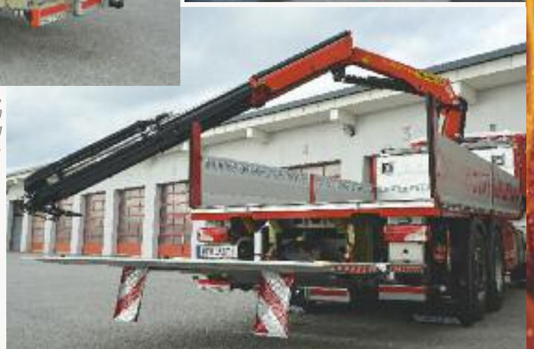
Damit das Verladen von Gegenständen, Paletten mit Sandsäcken, Schadstoffcontainer einfach und schnell durchgeführt werden kann verfügt das neue, genauso wie das alte Lastfahrzeug über eine Ladebordwand.
