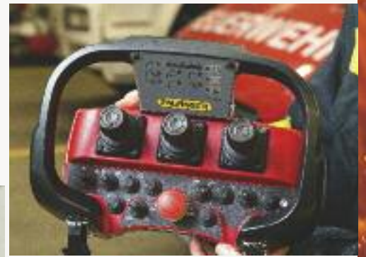
Der Kran kann mittels Steuermodul ausgefahren werden und in viele verschiedene Positionen gebracht werden, hinsichtlich Höhe und Weite.
