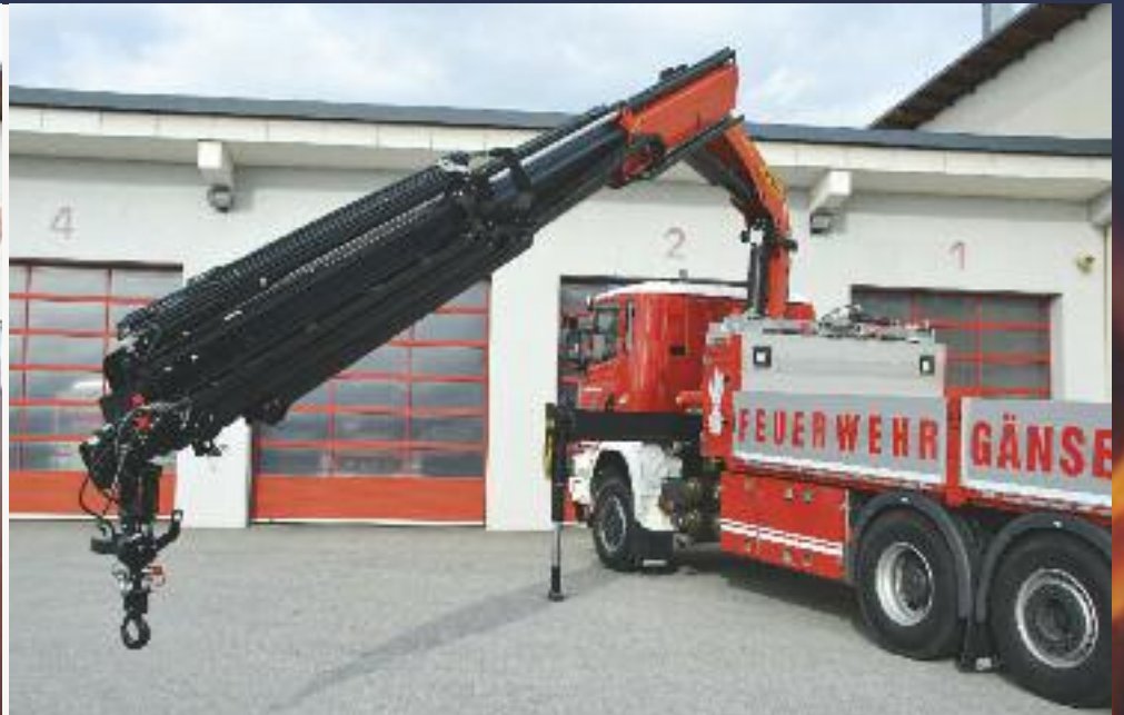
Der Kran kann mittels Steuermodul ausgefahren werden und in viele verschiedene Positionen gebracht werden, hinsichtlich Höhe und Weite.
