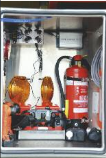
Fahrerseitig befinden sich ein Feuerlöscher, Lampen, Gerätschaften für die Verkehrsregelung sowie das Steuermodul für den Kran. Vorteil des Steuermoduls ist, dass sich der Maschinist „frei“ bewegen kann und immer die Übersicht behalten kann und bei Gefahren oder Problemen rasch eingreifen kann.
