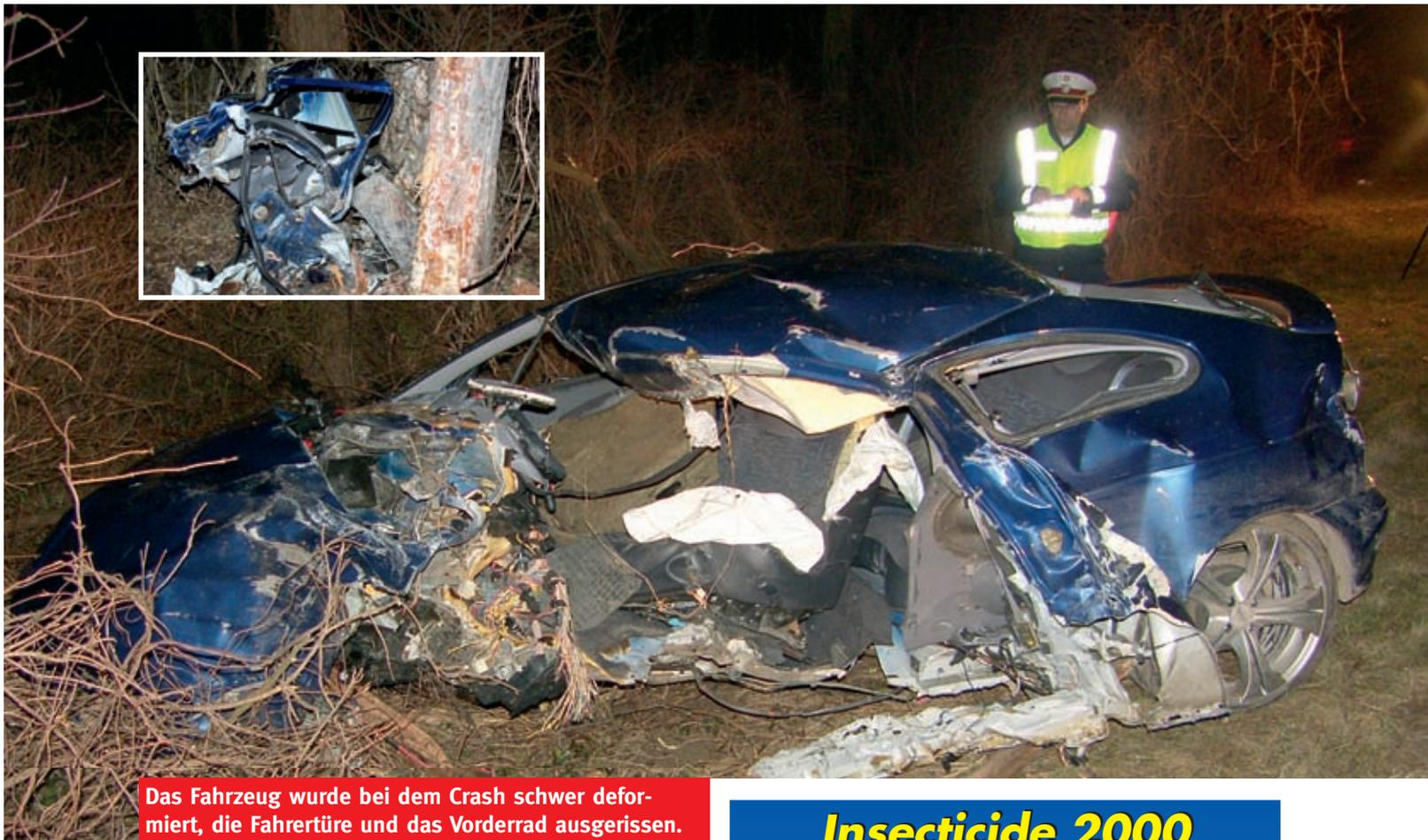
Das Fahrzeug wurde bei dem Crash schwer deformiert, die Fahrertüre und das Vorderrad ausgerissen.
