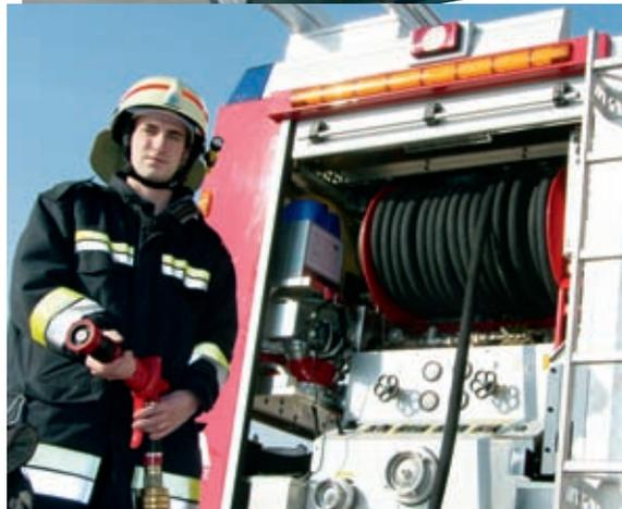
ausgelegt. Niederdruckeinbaupumpe „FireDos“ mit einer max. Durchflussmenge von 500 l/min bei bis zu 16-bar-Betriebsdruck, 500-l-Löschwassertank, stufenlos einstellbare Schaumzumischrate 0,3 bis 3 %, auch zur Zumischung von Sonderlöschmittel geeignet! Schnellangriffseinrichtung C 42 Wasser und Schaum, fix angeschlossener „Schnellangriffsverteiler“ zur
