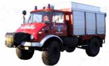
Durch die hohe Beweglichkeit, Geländegängigkeit und einer Seilwinde fährt dieses Fahrzeug vor allem bei Fahrzeugbergungen und anderen technischen Einsätzen aus. Neben der bereits erwähnten Seilwinde ist das Rüstfahrzeug mit einem Stromerzeuger, Kettensägen, Tauchpumpen, Hebekissen und allem nötigen Kleingeräten und Werkzeugen für technische Einsätze beladen.
